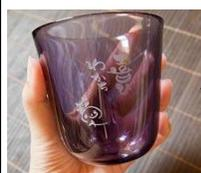
サンドブラストとは… 圧縮エアを利用してガラス等の素材の表面に細かな砂を吹き付け文字や模様などを彫刻する技法です。
