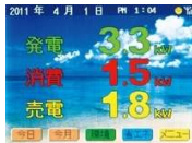
発電・電力消費売電状況をでか文字表示
